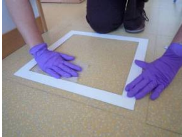
Figure 3-3 : Prélèvement de poussières au moyen d'une lingette
