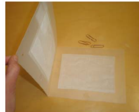
Système de collecteur passif pour la récupération des poussières sédimentables (4 semaines en place)
